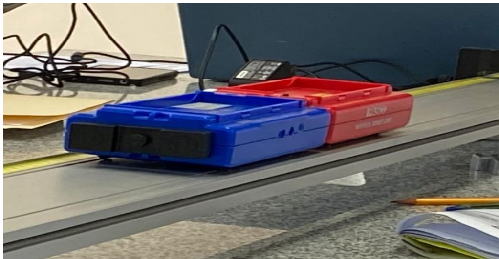
Figura 4. Montaje experimental para colisiones perfectamente inelástico.
