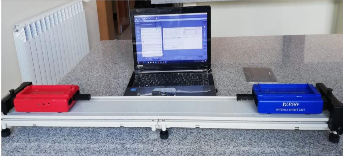
Figura 5.. Montaje experimental para colisiones elásticas.
