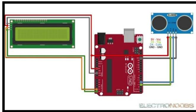
2. **Proceso de medición:** El sensor ultrasonido HC-SR04 mide la distancia de un objeto en movimiento en intervalos de tiempo fijos (1 segundo) en dos direcciones: primero en la dirección x y luego en la dirección y.
